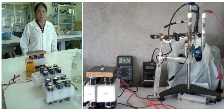
Figura 1. A la izquierda, baterías armadas por Y.M.M. utilizadas en la generación de H 2 . A la derecha una batería alimentando al electrolizador
